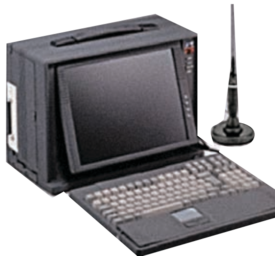
➤ Аппаратный GSM-снифер. Именно так обычно выглядят EMSI-catcher'ы!
